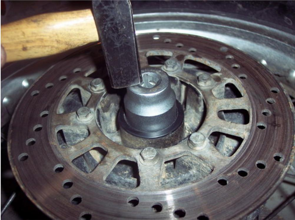
10. Simmerring rechts (neu!) eintreiben. Hohlräume des Dichtrings zuerst mit Fett auffüllen.
