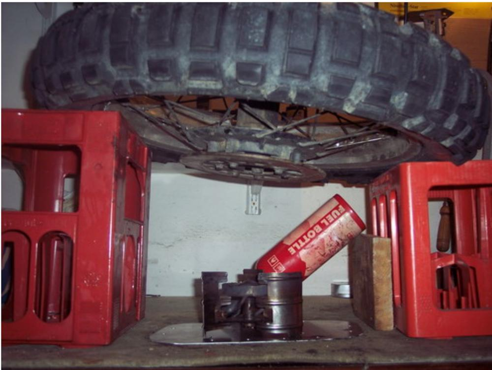
5. Wenn die richtige Temperatur erreicht ist (Fingerprobe mit Spucke), mit einer Stahlstange (z.B. Halbzoll-Verlängerung aus dem Nusskasten) das "einfachere" Lager zuerst ausschlagen (siehe Schritt 3). Der Simmerring auf der rechten Seite wird vom Lager mit heraus gedrückt.
