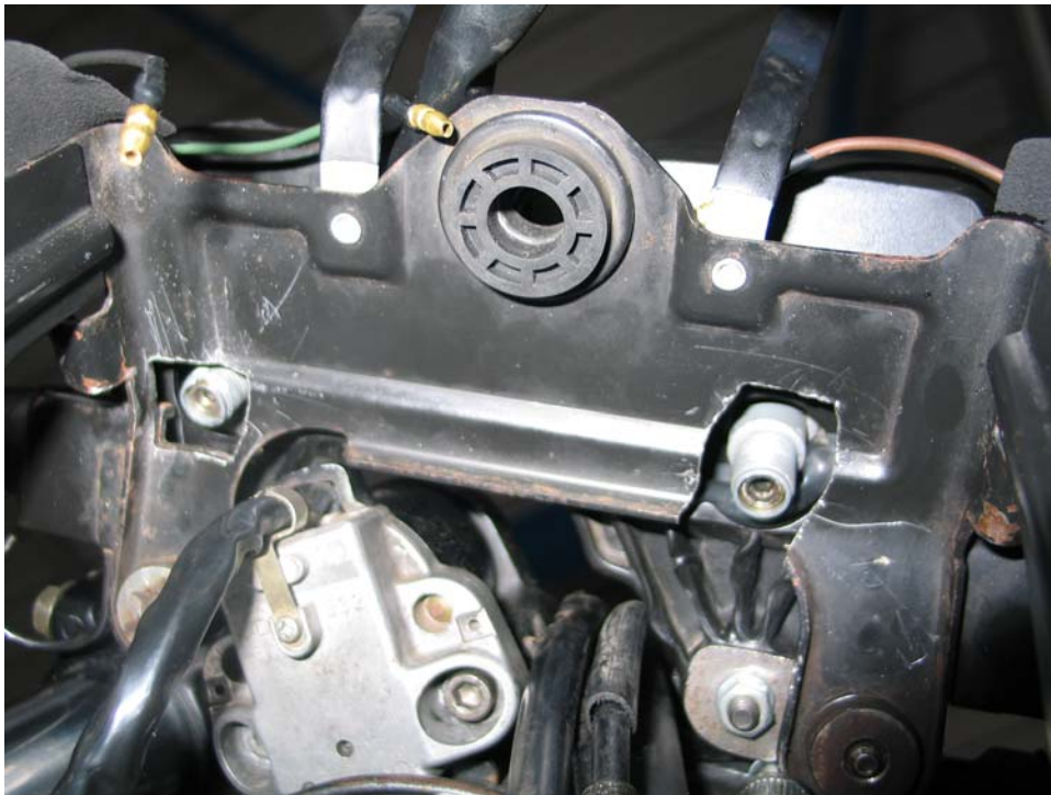
(modifizierte Scheinwerferhalterung – mehr Platz für die Wellen)
