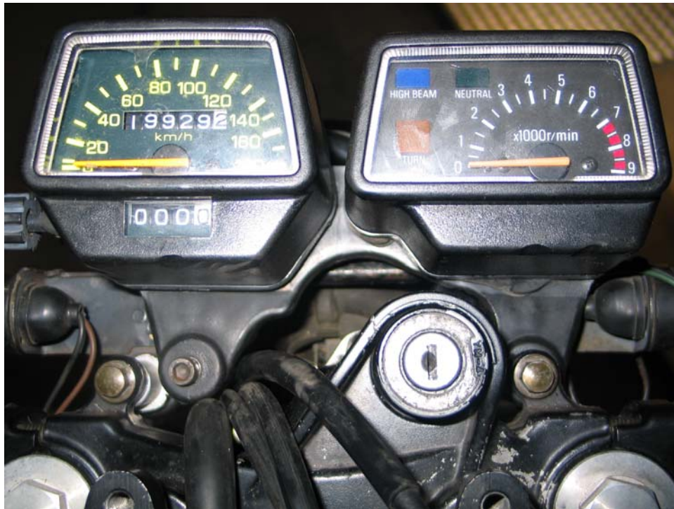
(Distanzhülse und probeweise eingebautes vollständiges Cockpit)
